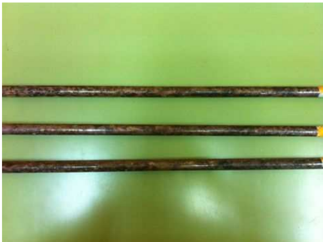
1.- Muestras después del ensayo ambiental (Niebla salina + Atmósfera húmeda sulfurosa)
